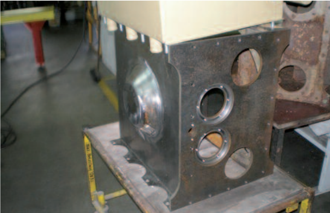
Eines der beiden neu gefertigten Lüftergehäuse, die links und rechts. Im Motorraum jeweils zwischen die beiden Motorkühler (ebenfalls bereits angefertigt) montiert werden
