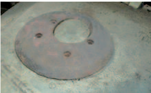
Die aus Polen beschaffte Panzerplatte mit Ausschussöffnung der Nahverteidigungswaffe
