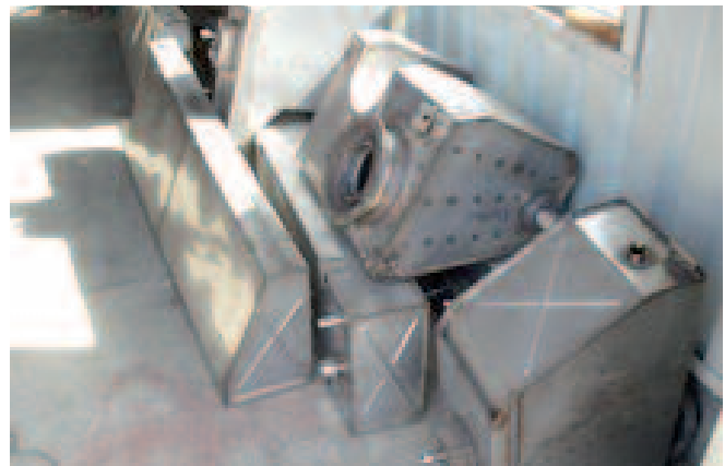
Die sieben neu angefertigten Benzintanks
