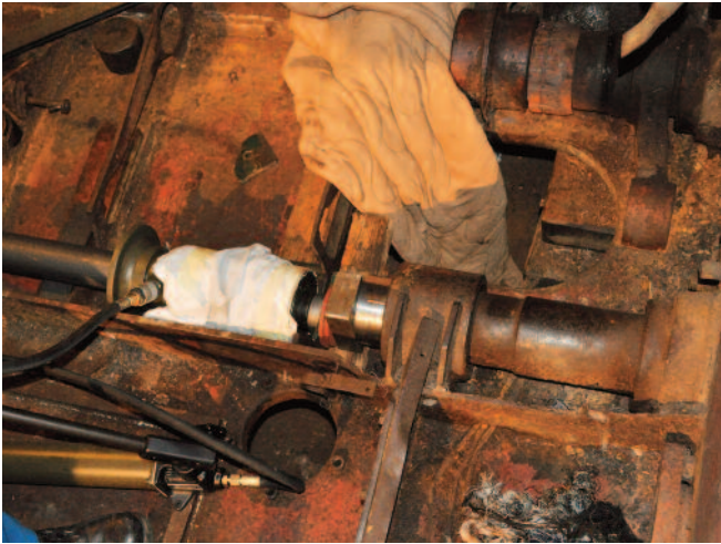
Auch der renitensteste Schwingarm musste kapitulieren ... gegen 20 Tonnen Druck ...
