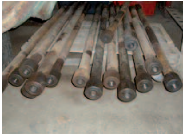
Die Torsionsstäbe (Drehfederstäbe) nach dem Ausbau
